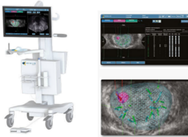
FIGURE III.3 – Dispositif d'assistance à la navigation avec fusion 3D US-IRM : Trinity® (Koelis, France). La plateforme intègre un échographe associé à une interface de visualisation de cartographie des carottes. La plateforme a été commercialisée et approuvée FDA en 2016 et est depuis couramment utilisée par les urologues pour des procédures de biopsie. Toutes les images sont traitées en B-mode.
