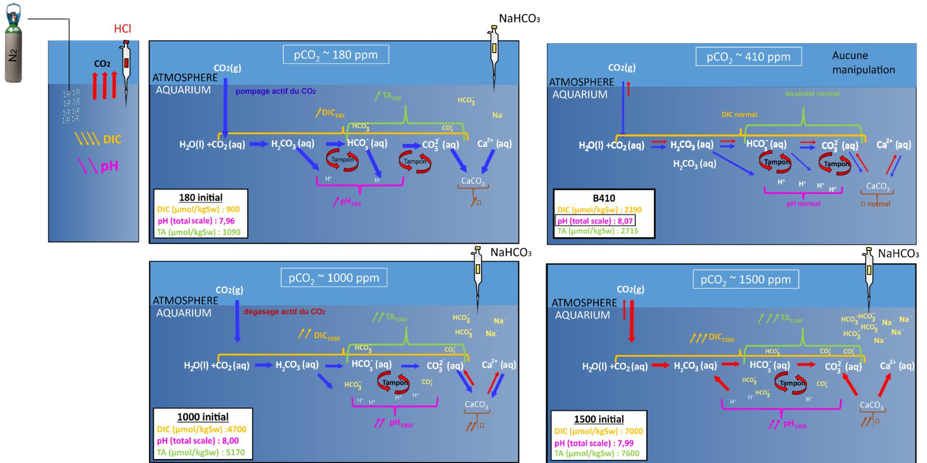
Figure II- 10. Conditions des quatre aquariums traités à des concentrations de  $\text{NaHCO}_3$  différents pour maintenir le  $\text{pH}$  constant : set up
