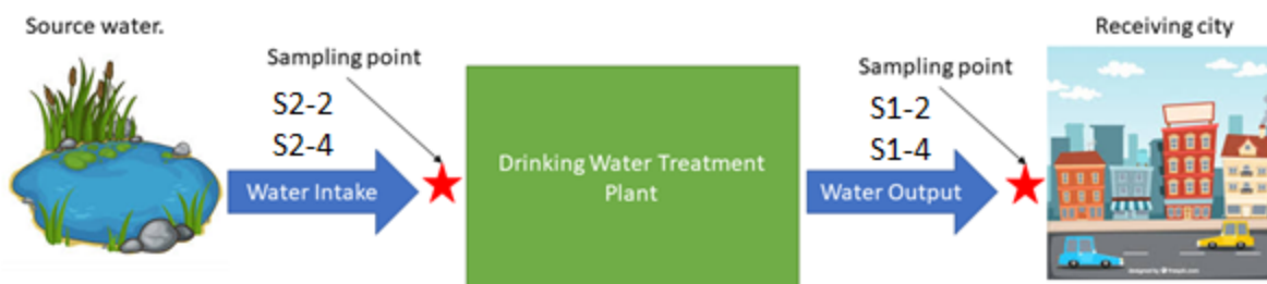
Figure 5 : Stratégie d'échantillonnage de l'EIL organisé dans le réseau NORMAN (2019)
