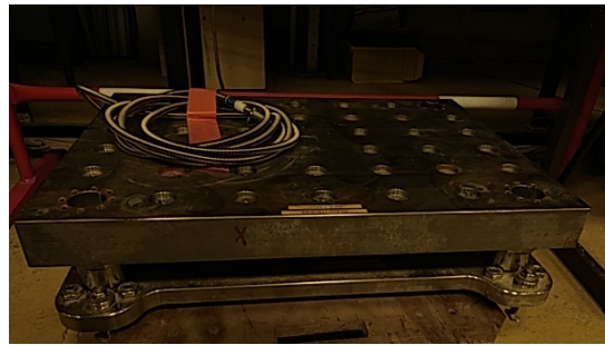
(b) Photo de la balance d'effort en dehors du canal.
