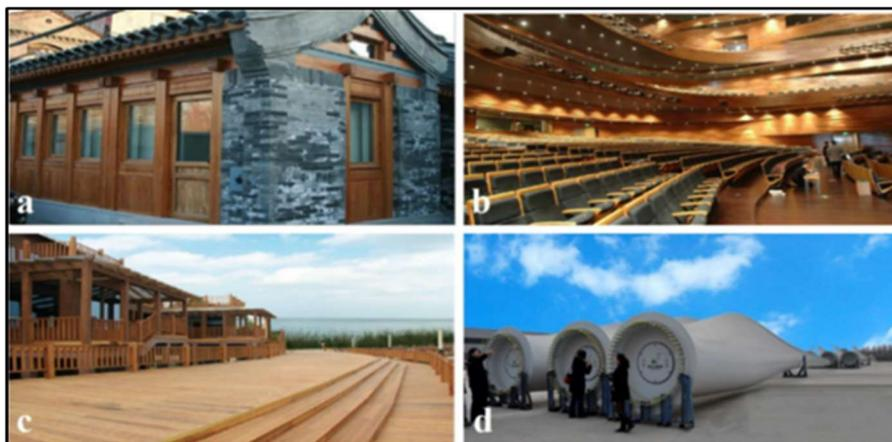
Figure II-43 Exemple d'application des scrimber de bambou a) fenêtre et portes b) décoration intérieure c) matériaux extérieurs d) pales de turbines d'éoliennes ((Huang et al., 2019)
