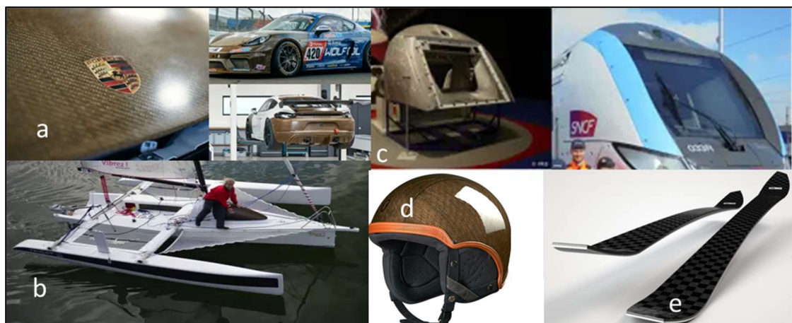
Figure II-30 illustrations de biocomposites à base de lin a) Habillage de la voiture de course Porsche 718 Cayman GT4 b) Gwalaz, le premier trimaran 100% fibres de lin c) Cabine de train Regio 2N de Bombardier en fibres végétales d) Casque de ski (EGIDE) e) Ski Rando RAL 169 (Clone) dont la structure renforcée par du carbone et du lin
