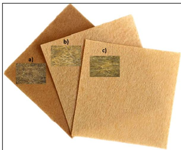
Figure III-31 Photographie et image en loupe binoculaire des mats de fibres bambou préparés à partir de traitement à la soude a) 30% b) 6% c) 1%
