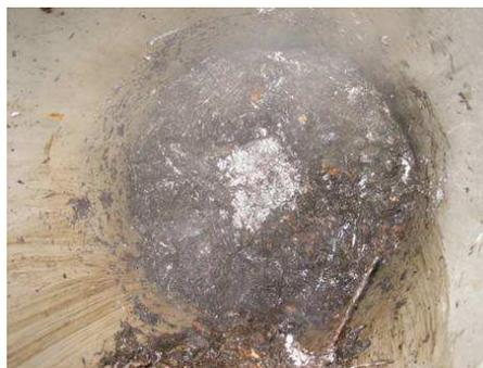
Figure 58 : Photographie du déchet à l'intérieur du silo après 28 jours d'expérimentation : le centre est très sec par rapport à ce qui peut être observé proche de la paroi.
