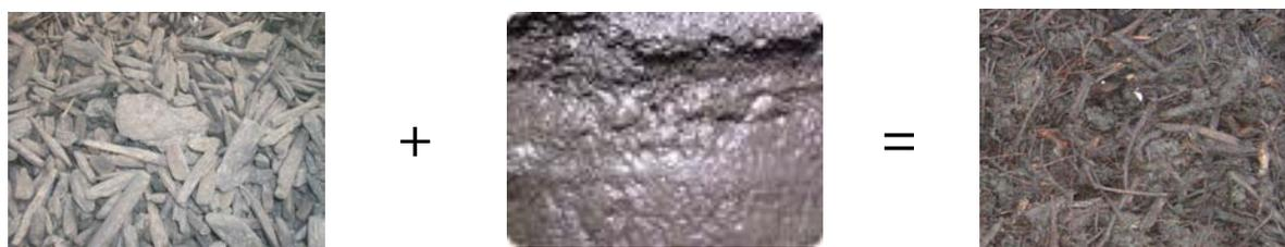
Figure 8 : Mélange de boue et d'un co-produit afin d'augmenter la porosité de la boue, et donc l'accessibilité à l'oxygène pour les micro-organismes.
