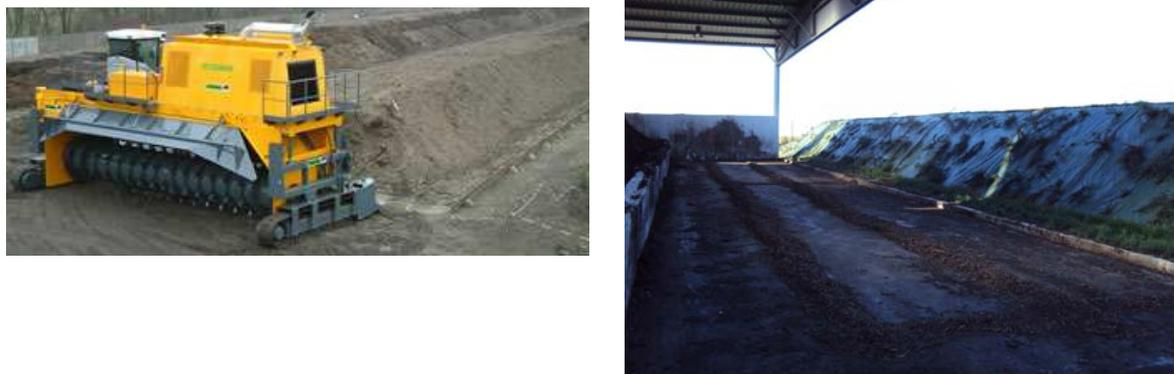
Figure 11 : Les différentes méthodes d'aération : le retournement (à gauche : <http://www.mat-environnement.com/materiels/article/2009/04/02/27931/retourneur-andains.php>) et l'aération forcée illustrée ici par l'utilisation de deux tuyaux (à droite).
