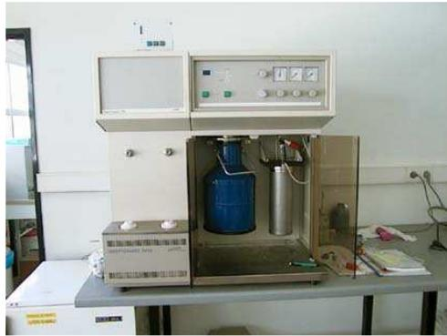
Figure 28 : Porosimétrie par intrusion de mercure (<http://www-ipcms.u-strasbg.fr>)
