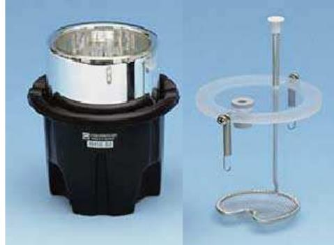
Figure 35 : Exemple de calorimètre (<http://www.physique.ens-cachan.fr/laboratoire/materiel/show?id=407&action=show>)
