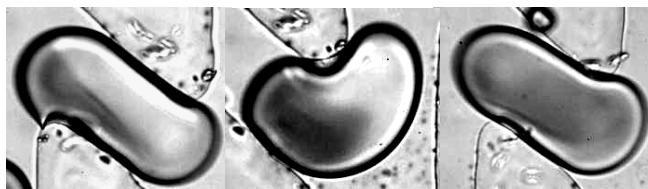
Figure 1-17 : Mélange par advection chaotique dans des gouttes lors de leur passage dans des coudes [117]
