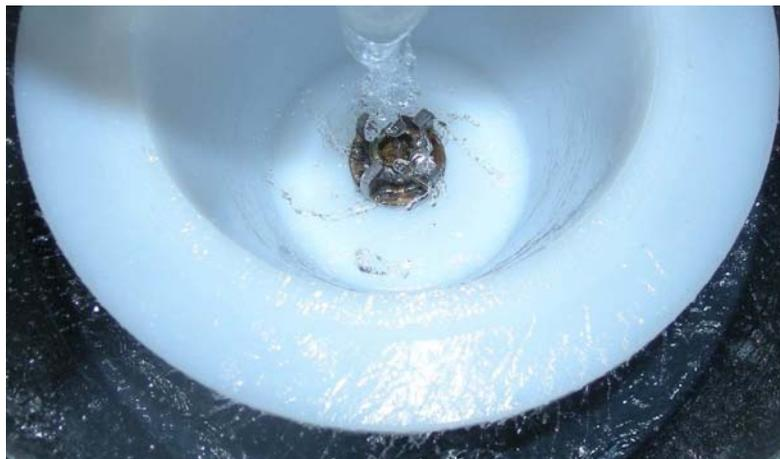
**Figure A.5:** Visualisation de l'épaisseur du film et de l'accélération du fluide par l'hélice dans un bol lisse sans zone de rétention (cônique sur toute sa longueur).
