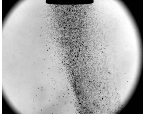
FIGURE 6.5 – Exemple de battement
