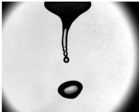
FIGURE 6.4 – Exemple d'atomisation insuffisante
