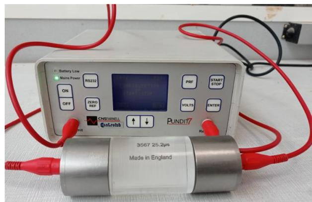
*Figure 2.18: Accéléromètre, transducteurs, échantillon pour étalonnage.*
