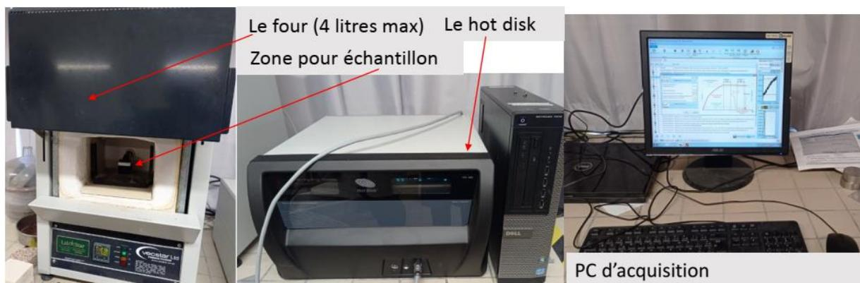
*Figure 2.10: Dispositif expérimental de mesures de propriétés thermiques*
