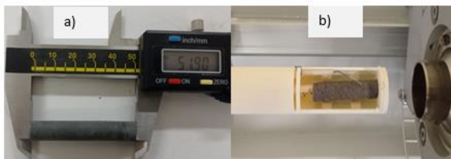
Figure 3.5: Image d'échantillon de roche de basalte : a) avant essai et b) après essai
