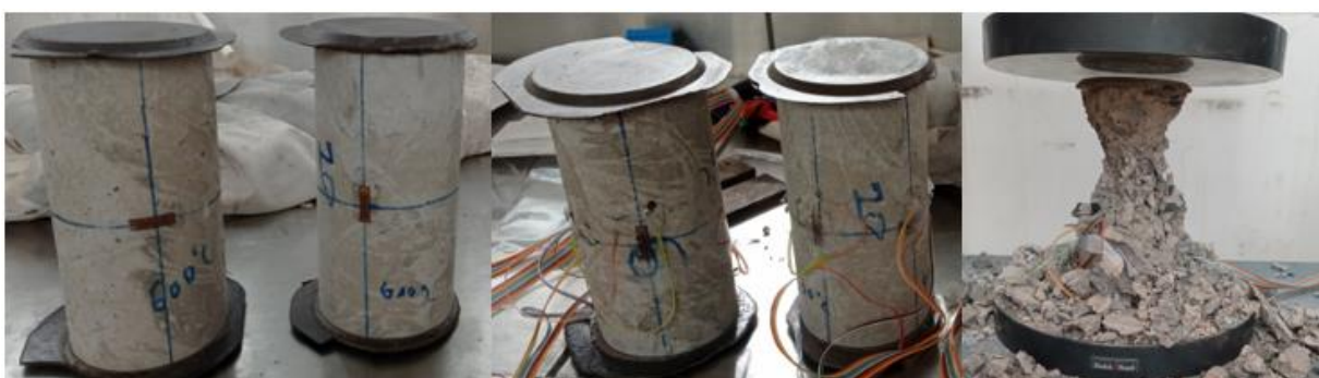
Figure 2.17: Eprouvette prête à l'essai et observation après essai
