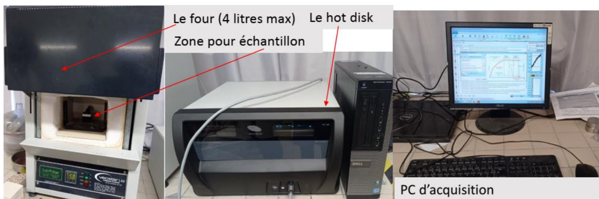
Figure 2.10: Dispositif expérimental de mesures de propriétés thermiques
