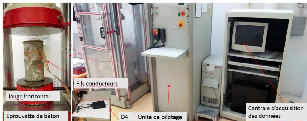
Figure 2.16: Dispositif expérimental de mesure des résistances en compression.
