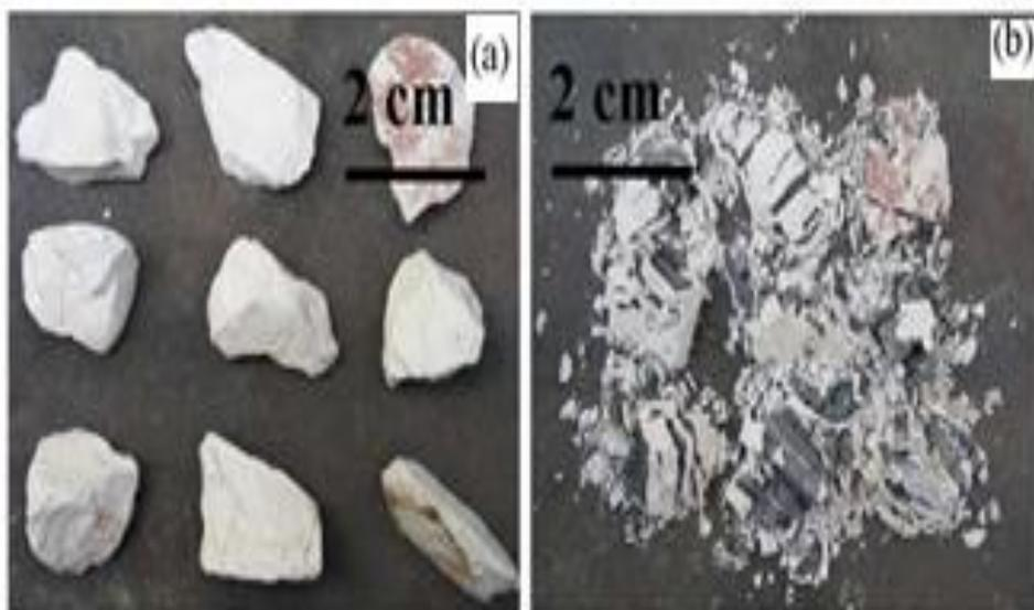
*Figure 1.5: Comparaison des granulats calcaires avant et après la transformation de CaO en portlandite après le chauffage à 750 °C, a) Immédiatement après le cycle de chauffage-refroidissement de 750 °C, b) trois jours après le cycle de chauffage-refroidissement à 750 °C (Xing,2011)*
