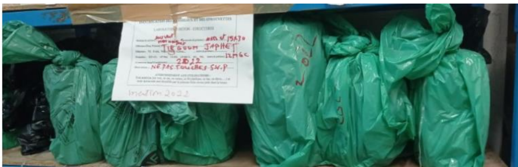
Figure 2.6: Maintien dans des sacs plastiques étanches apposés d'un numéro d'identification unique et stockage dans la salle.
