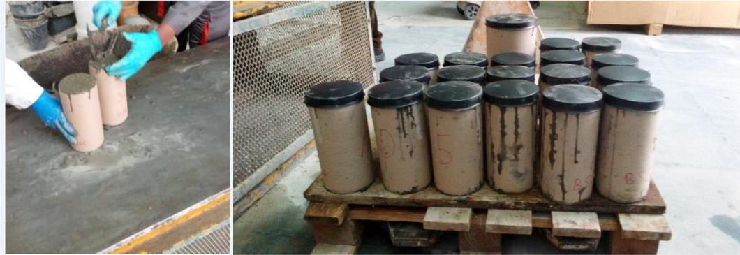
*Figure 2.3: Table vibrante et éprouvettes.*
