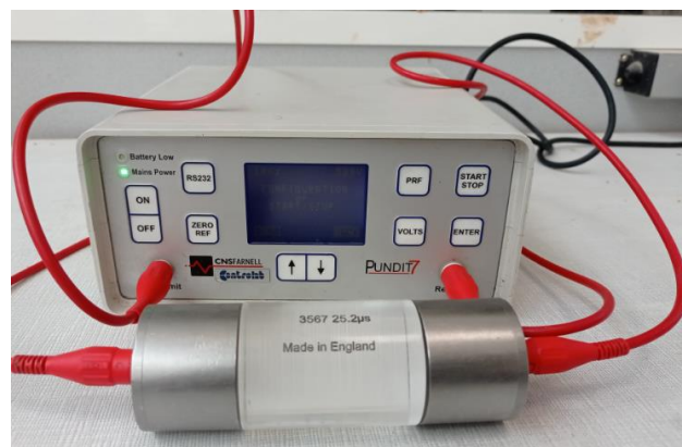
Figure 2.18: Accéléromètre, transducteurs, échantillon pour étalonnage.
