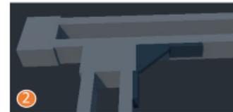
Dans le cas où une came entrée et placée à la fin d'une unité, le simulateur sait déjà comment placer l'unité suivante, mais il va la coller à l'unité précédente (comme dans le cas 1). Il est cependant possible de reculer l'unité aval grâce au paramètre offset. Par exemple un offset de 100 mm (le cas 2)
