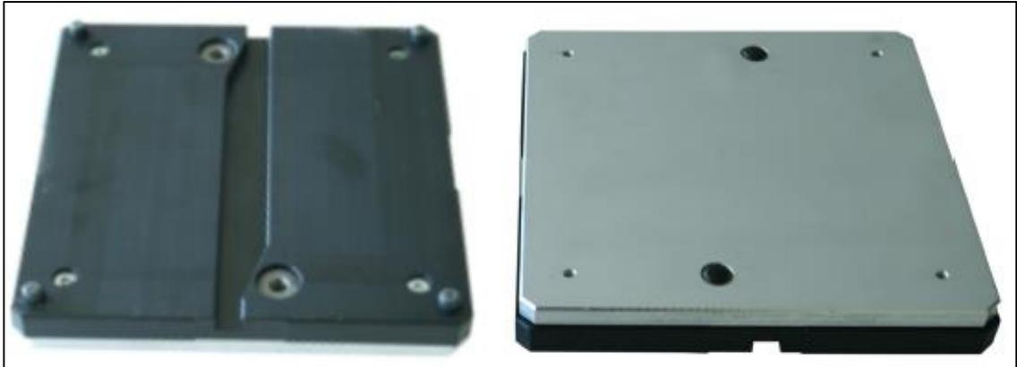
*Figure 39 Une palette, à gauche vu du dessous et à droite du dessus*
