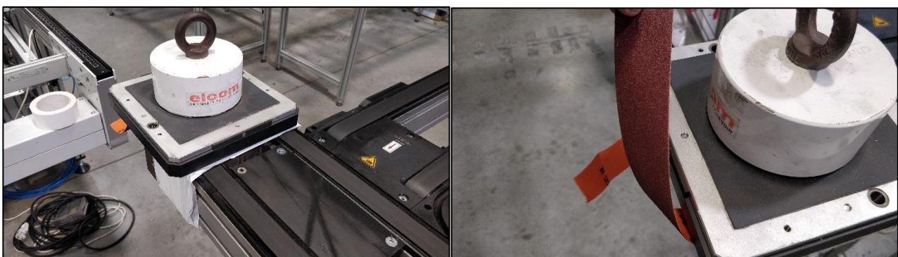
Figure 24a et 24b photographies des feuilles abrasives servant à endommager les bandes de convoyages
