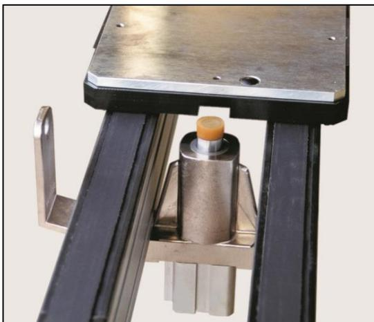
Figure 12 a Photo d'une butée
