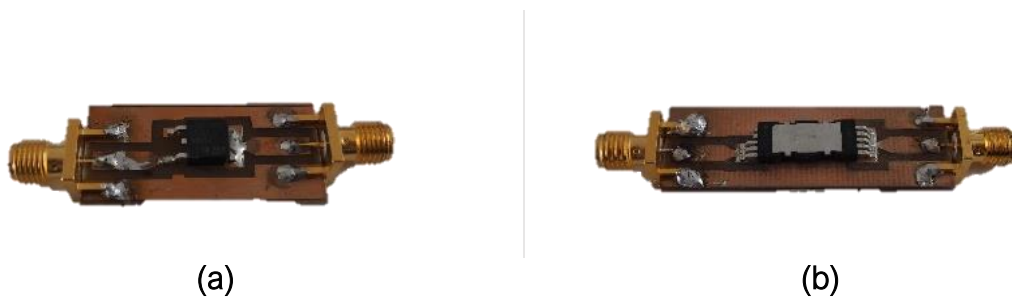
Figure II.22 – Diodes SiC et leurs dispositifs de caractérisations associés (a) STPSC8Ho65BD (b) IDDDo4G65C6XTMA1
