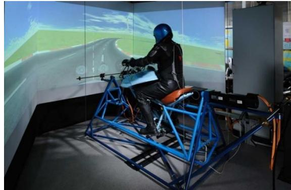
*Figure 2.16 Simulateur de moto Université de Padoue (Cossalter, Lot, Massaro, et al., 2011)*
