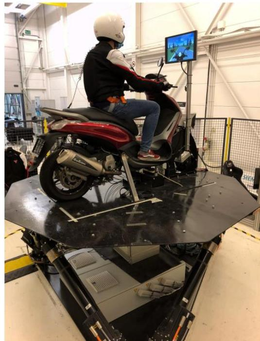
*Figure 2.18 Simulateur de moto MOTORIST, Université Technique de Delft (Grottoli, 2021)*
