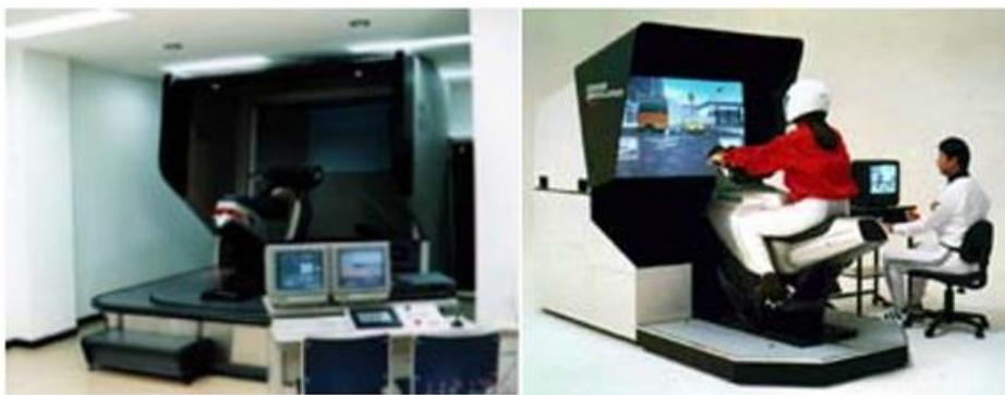
*Figure 2.10 Prototype n°2 du simulateur de moto Honda*
