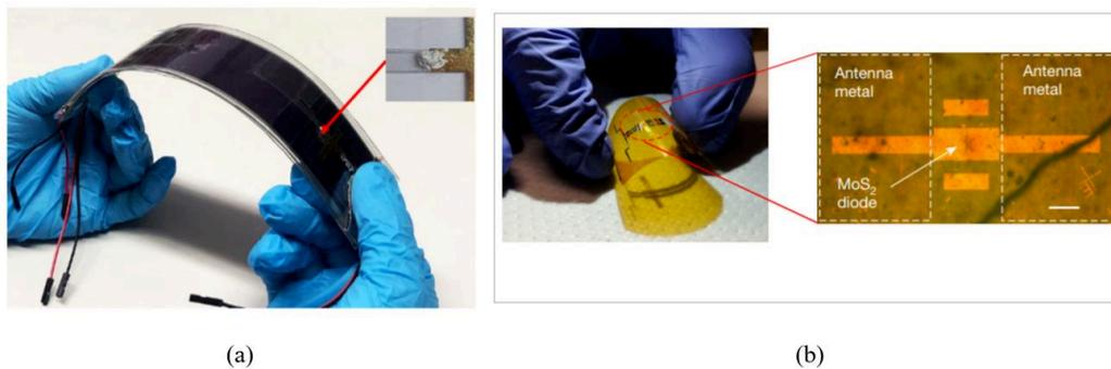
**Figure I-18.** Récupérateur d'énergie (a) hybride RF/solaire [101] (b) électromagnétique [102]
