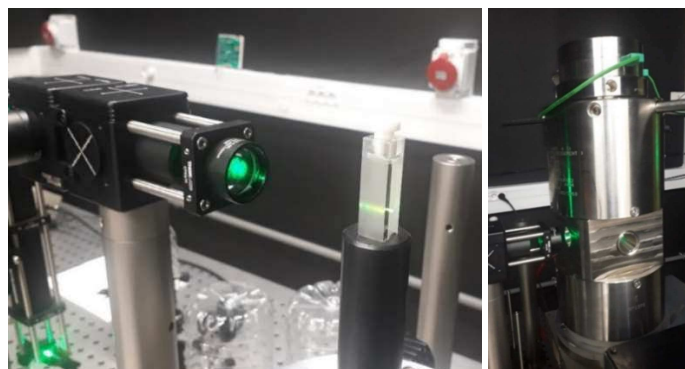
Fig. 2.13. A gauche, le laser Raman vert (514.5 nm) dont le faisceau traverse l'échantillon contenu dans une cuve en silice fondue. A droite, le réacteur hydrothermal permet de monter à haute pression et température pour une analyse in situ du fluide.
