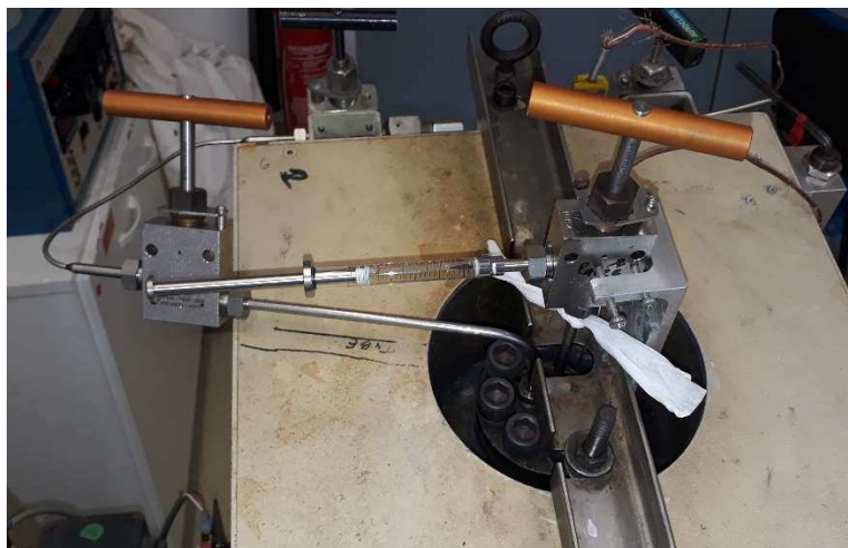
Fig. 2.4. Prélèvement du fluide expérimental dans la cellule du Coretest® avec une seringue en verre Gastight™.
