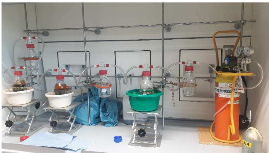
Fig. A.2. Montage expérimental de synthèse de solutions de NaHS. Le flacon central contient la solution de NaOH dans laquelle on fait barboter du H 2 S provenant de la bouteille de gaz (à droite). En sortie du montage (à gauche sur la photo) on peut voir deux flacons contenant du sel de Mohr. Entre ces flacons se trouvent des flacons de « garde » qui évitent des retours de fluide par aspiration, que ce soit dans le flacon réactionnel ou dans la bouteille de gaz.
