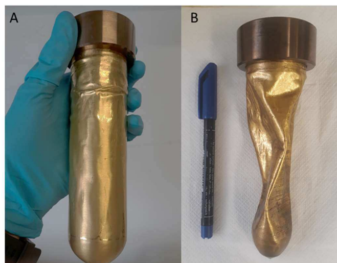
Fig. 2.2. Images de la cellule en or avant (A) et après (B) l'expérience m34. Les parois flexibles de la cellule se sont écrasées sous l'effet de la pression et du plus faible remplissage de la cellule en fin d'expérience (~60 % du volume total).
