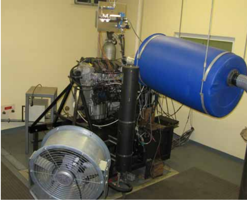
FIG. 3.6 – Implantation du moteur sur le banc d'essai SuperFlow SF901
