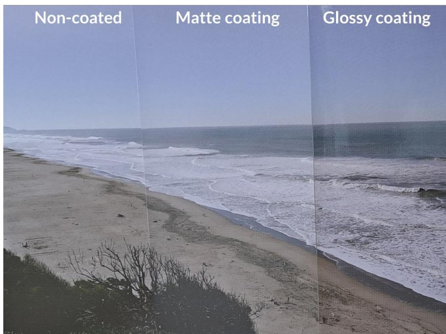
Figure R.1. Photo d'une impression jet d'encre non-pelliculée à gauche, pelliculée matte au milieu, et pelliculée brillante à droite.
