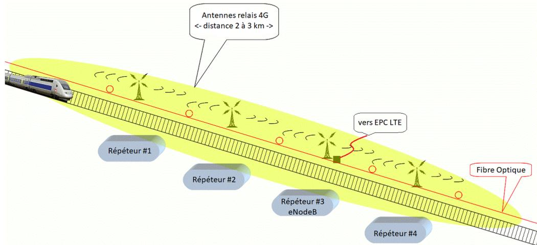
FIGURE 1.1 – Transmission LTE sur un TGV
