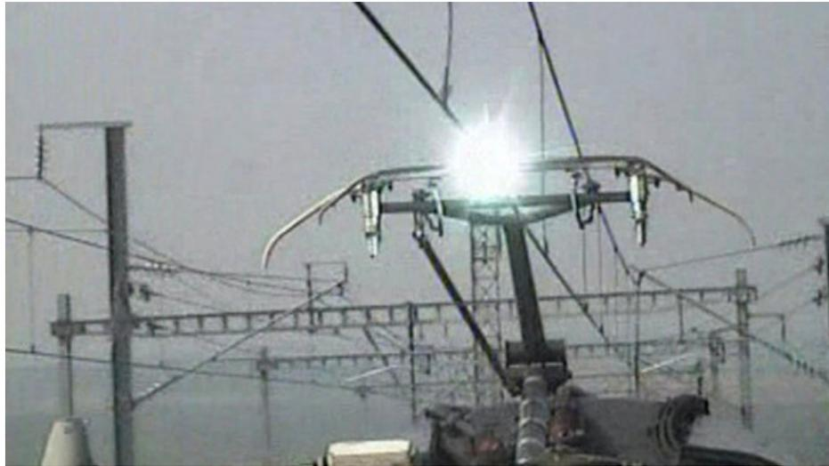
FIGURE 2.1 – décharge électrostatique caténaire/pantographe TGV
