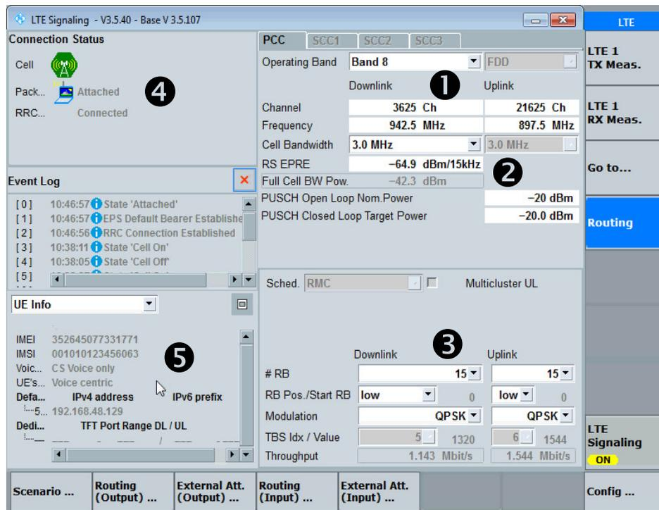
FIGURE 3.5 – fenêtre de configuration de la partie eNodeB
