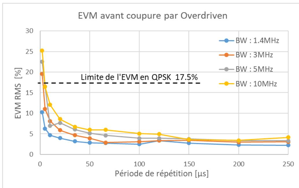
FIGURE 4.3 – EVM avant coupure de la communication LTE
