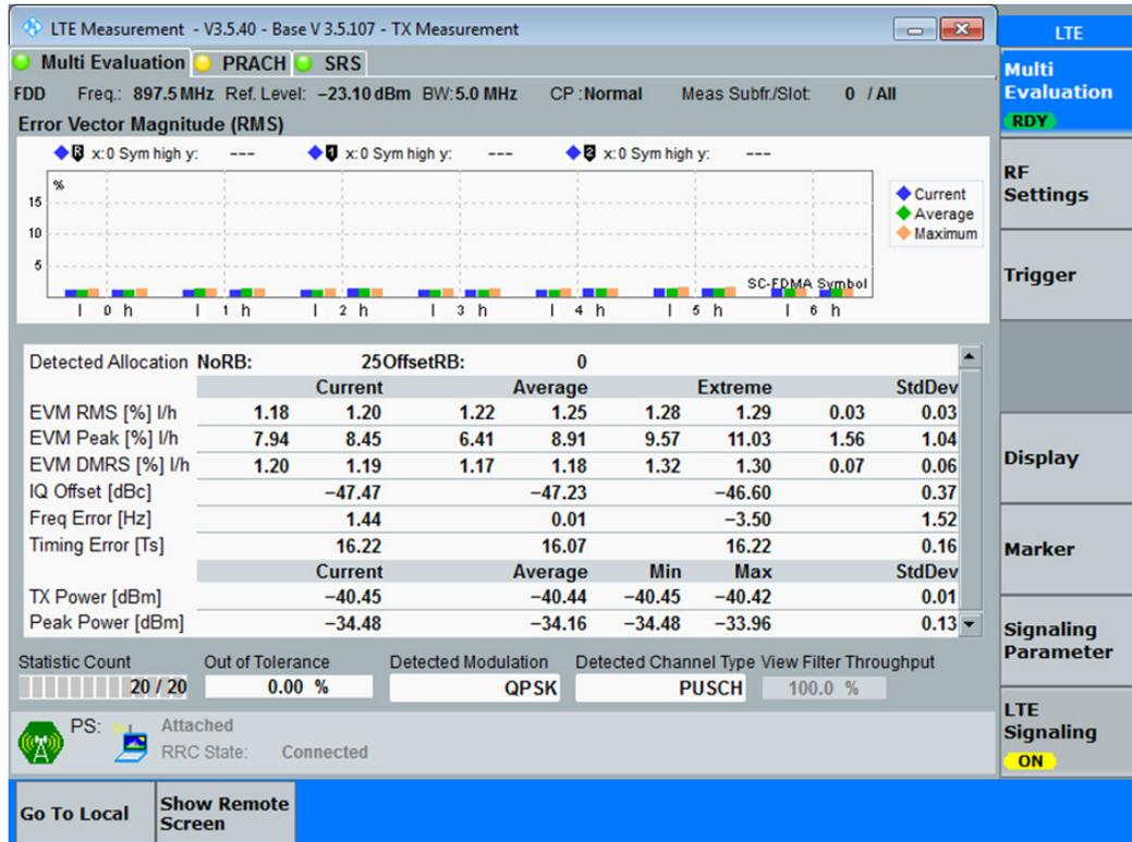
FIGURE 3.7 – Mesures de l'EVM sur le CMW500
