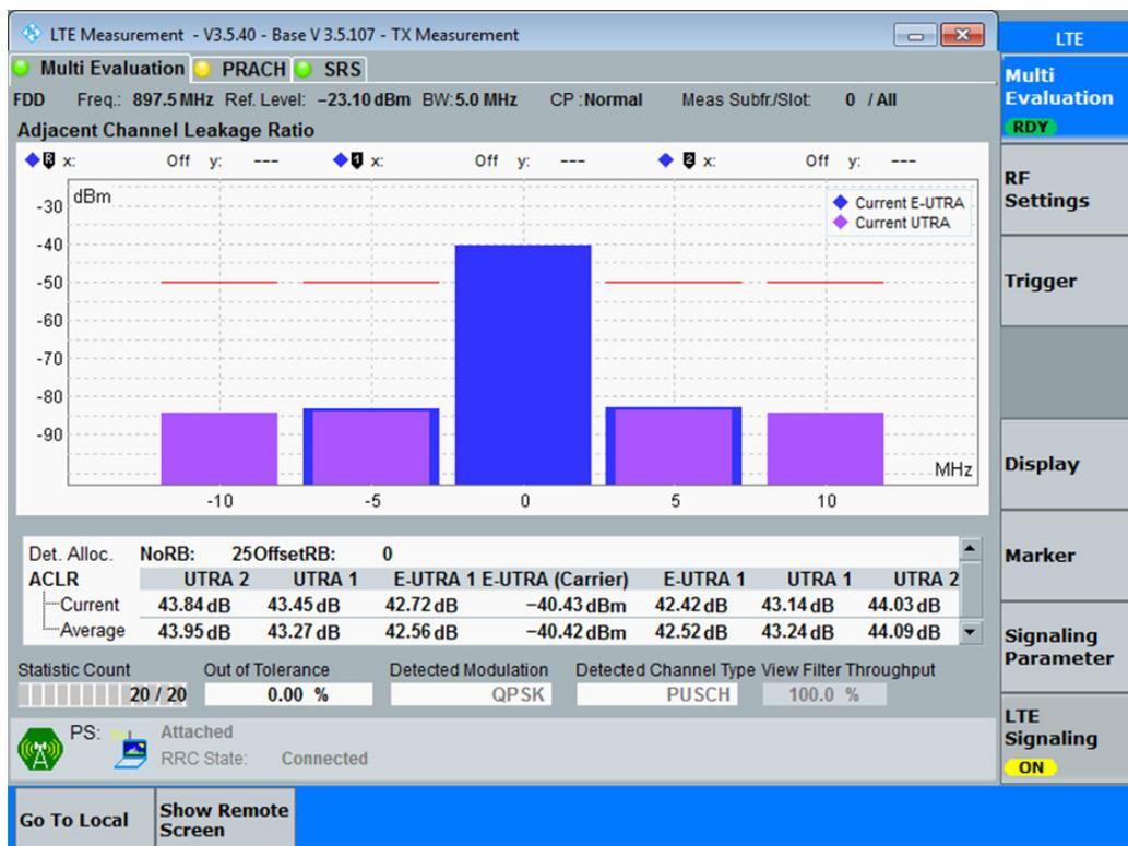
FIGURE 3.8 – Mesures de l’ACLR sur le CMW500
