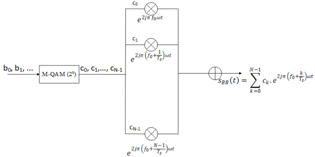
FIGURE 1.6 – Schéma de principe du modulateur OFDM
