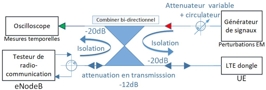
FIGURE 3.4 – Bilan des puissances du montage
