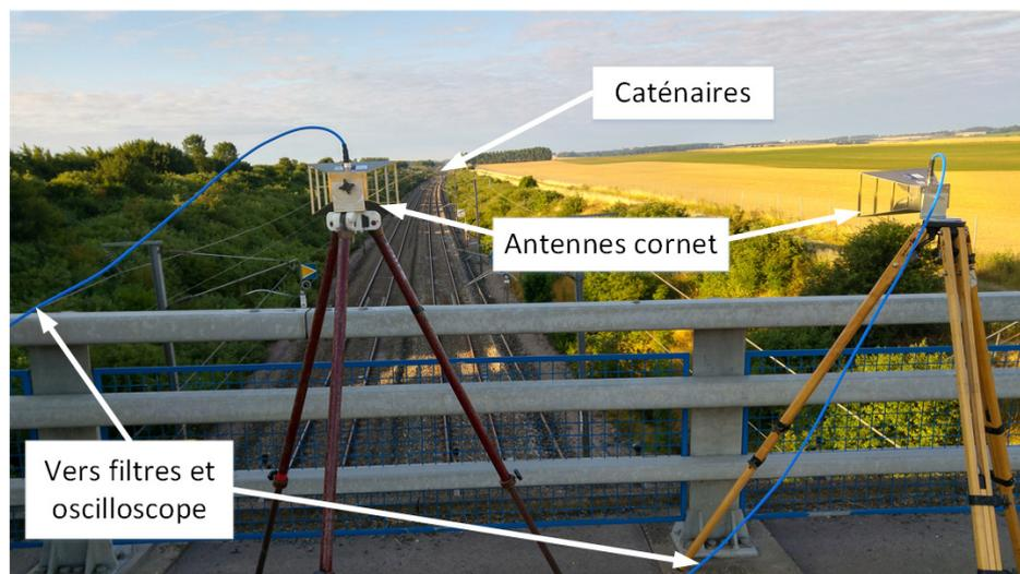
FIGURE 2.2 – Photo des antennes placées le long de la voie TGV
