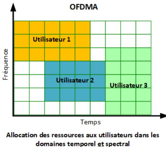
FIGURE 1.9 – Répartition des utilisateurs sur une grille l'OFDMA
