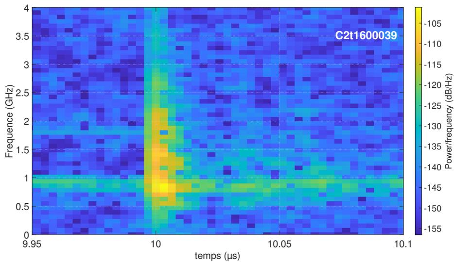
FIGURE 2.6 – Représentation temps/fréquence de l’interférence caténaire pantographe
