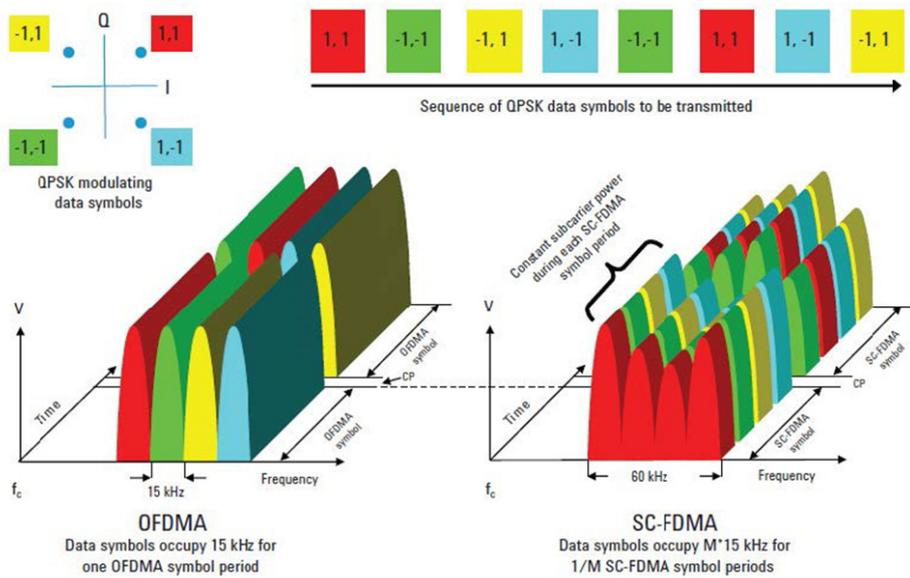
FIGURE 1.12 – Grilles temps-fréquences OFDMA et SC-FDMA (source Agilent)
