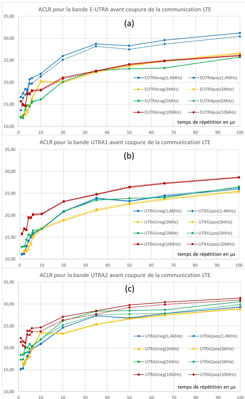
FIGURE 4.7 – ACLR avant coupure de la communication
