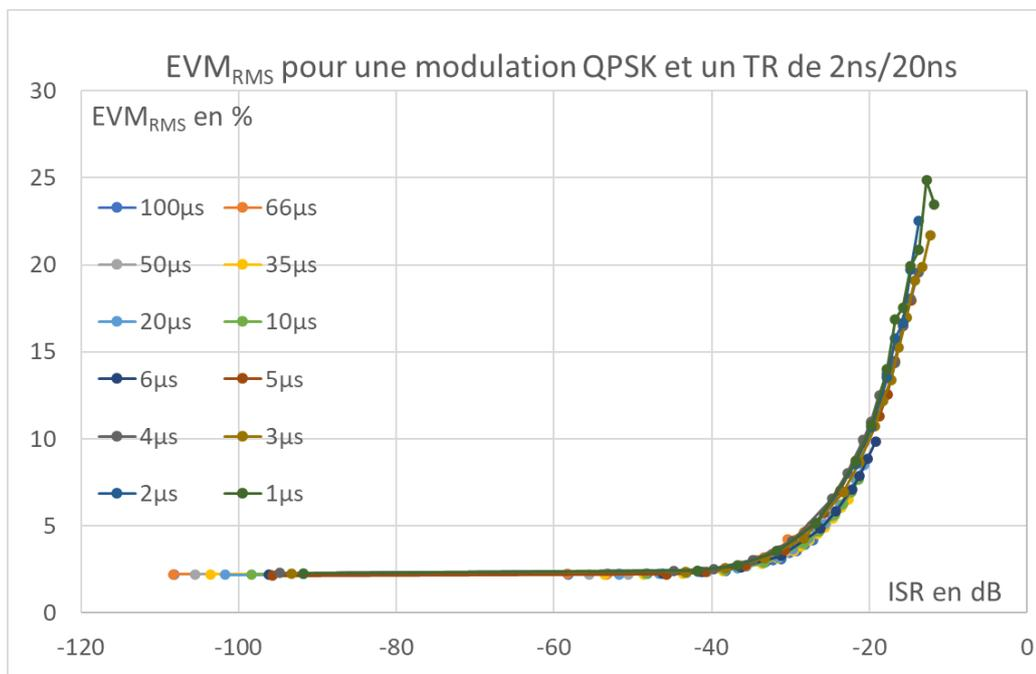
FIGURE C.3 – EVM fonction de l'ISR pour une bande allouée de 5MHz
