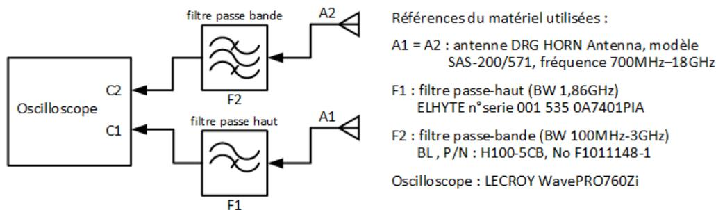
FIGURE 2.3 – Principe de mesure des interférences le long de la voie TGV
