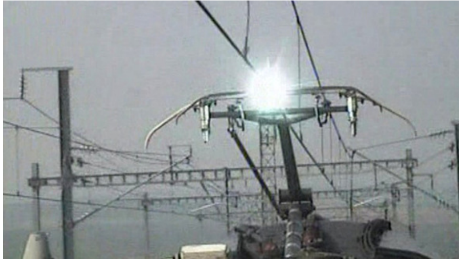
FIGURE 2.1 – décharge électrostatique caténaire/pantographe TGV
