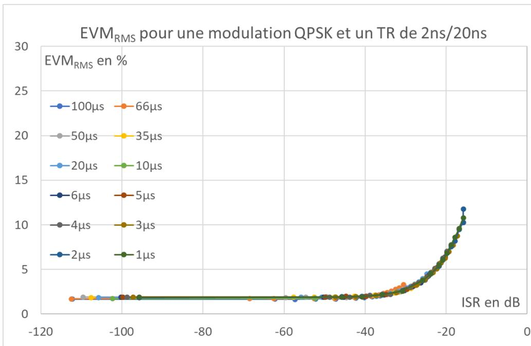
FIGURE C.1 – EVM fonction de l'ISR pour une bande allouée de 1,4MHz
