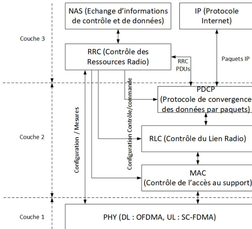
FIGURE 1.4 – Architecture du plan de contrôle Radio
