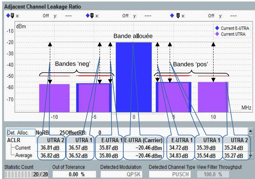
FIGURE 4.4 – Mesures de l’ACLR sur le CMW500
