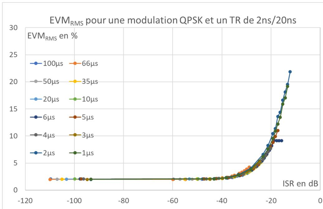
FIGURE C.2 – EVM fonction de l'ISR pour une bande allouée de 3MHz
