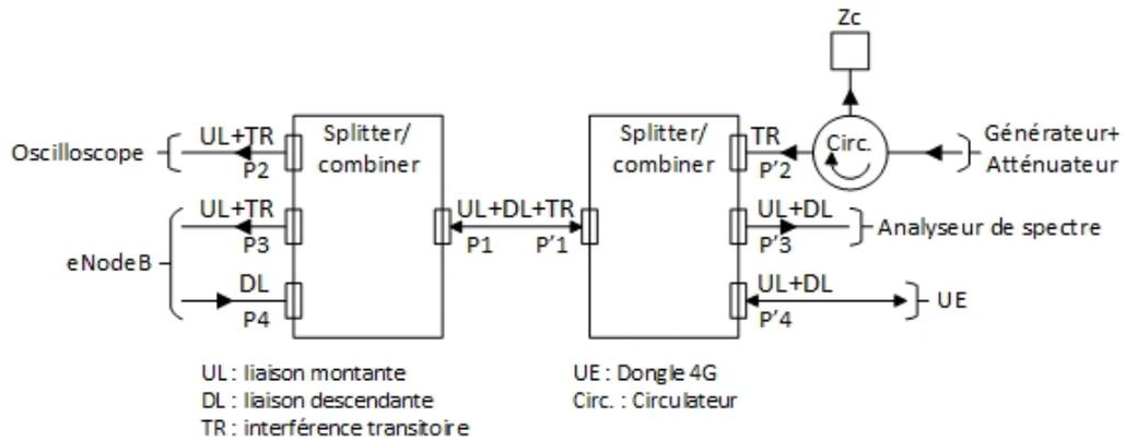
FIGURE 3.3 – Schéma de câblage de la partie conduite
