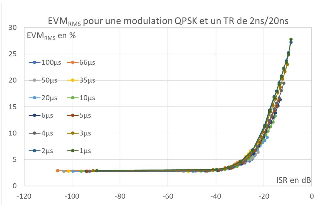
FIGURE C.4 – EVM fonction de l'ISR pour une bande allouée de 10MHz
