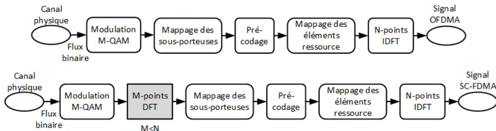
FIGURE 1.11 – Émission de signaux OFDMA et SC-FDMA
