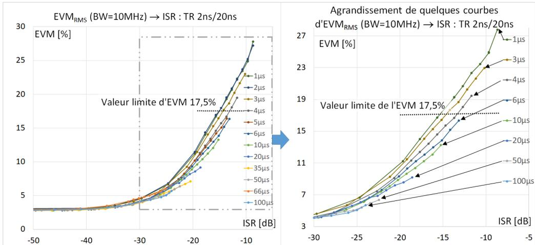
FIGURE 4.1 – EVM en fonction de l'ISR, pour une bande de 10MHz
