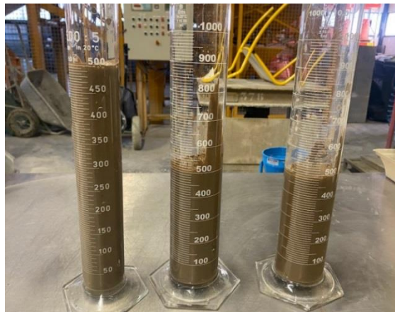
Figure 7-14 : Apparence visuelle des coulis pour l'essai de ressuage
