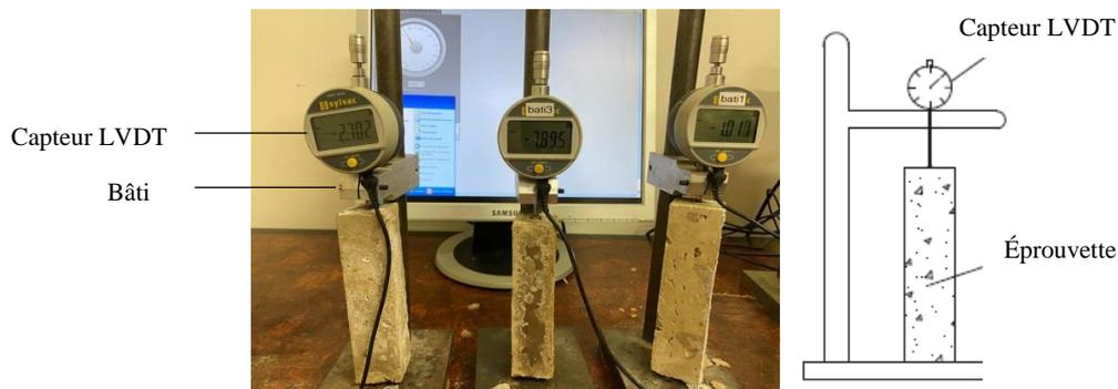
Figure 5-4 : Photographie du dispositif utilisé pour le retrait
