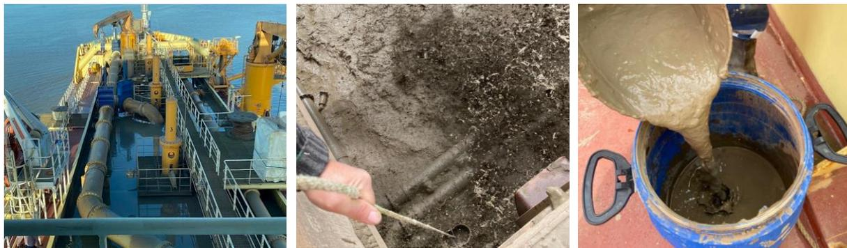
*Figure 2-6 : Étapes d'échantillonnages pour les sédiments de Bordeaux*
