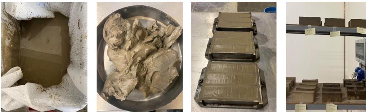
**Figure 3-12** : Étape de fabrication des éprouvettes – Du séchage des sédiments jusqu'à la cure
