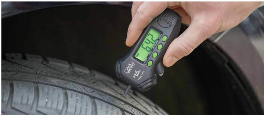
*Figure V-4: Exemple de jauge d'usure pour pneus*
