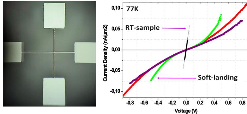
Figure Résumé 3: Jonction tunnel magnétique hybride  $Co/CH_3(CH_2)_{15}SH/Fe(001)$  (surface  $5 \times 5 \mu m^2$ ) préparée par dépôt sous masque. Courbes  $J(V)$  mesurées sur des jonctions préparées par soft-landing ou à température ambiante. Une caractéristique non-linéaire associée au transport tunnel à travers le peigne moléculaire est observée pour plus de 50% des jonctions mesurées.
