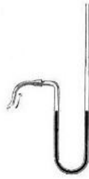
Figure 1.2: L'origine de la mesure de la pression artérielle en millimètre de mercure. L'hémodynamomètre de Poiseuille permet le calcul de la pression artérielle en additionnant le déplacement du mercure vers le bas sur la première branche au déplacement vers le haut sur la seconde. Crédit : Wikimedia Commons.
