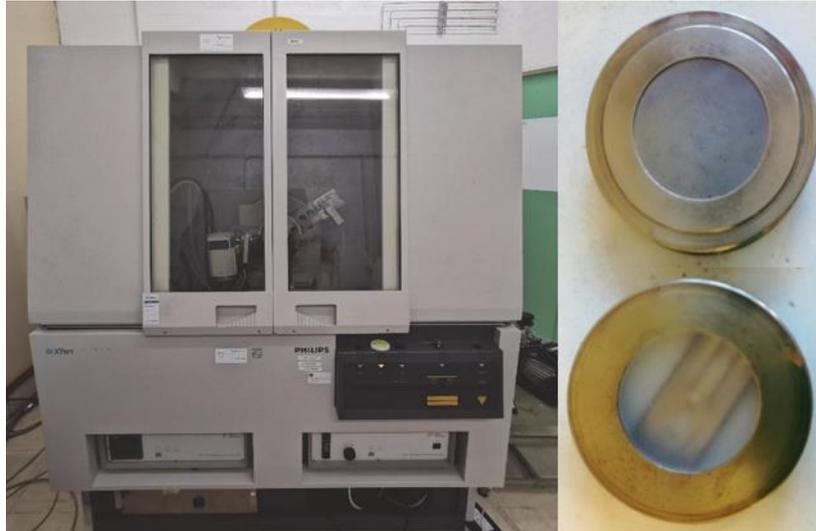
Figure 41°: Diffractomètre X'Pert Pro avec deux portes échantillons en silicium et en verre dépoli
