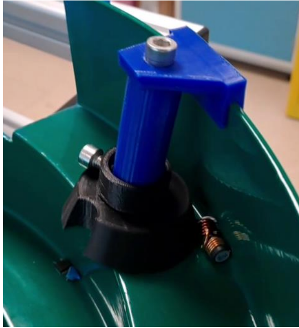
Figure 11 : Photographie de la pièce conçue pour espacer les EC montée sur le bol.
