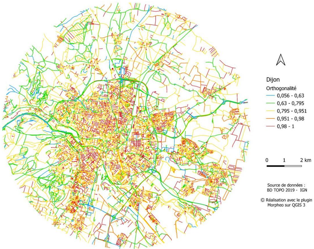
Figure 2.14. L'orthogonalité des voies calculée sur le réseau viaire de Dijon en 2019.
