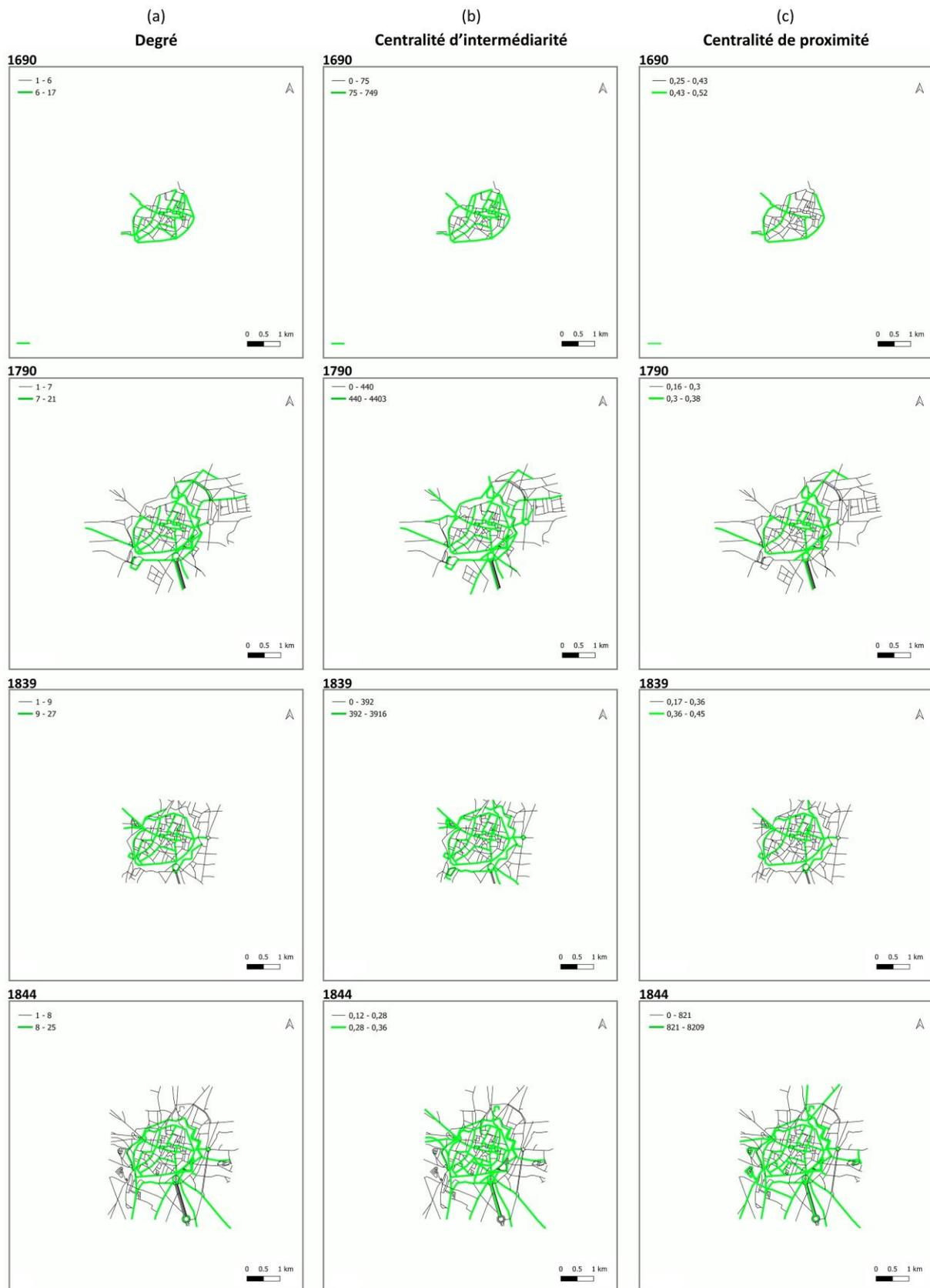
Figure 3.19. Les voies les plus centrales du réseau viaire de Dijon en 1690, 1790, 1839 et 1844, avec (a) un degré  $D_{(i)} > \frac{D_{max}}{3}$ , (b) une centralité d'intermédiarité  $B_{(i)} > \frac{B_{max}}{10}$  et (c) une centralité de proximité  $C_{(i)} > \frac{3 \times C_{max}}{4}$ .
