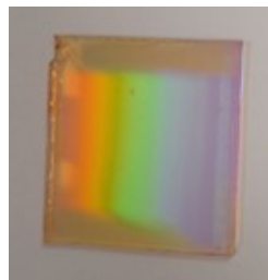
FIGURE 3.13 – Photographie d'un réseau master (résine).
