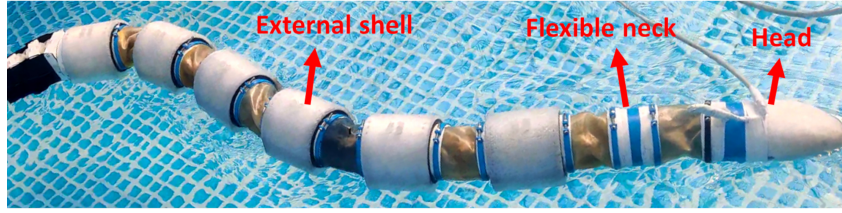
(a) Le prototype de robot serpentiforme Natrix
