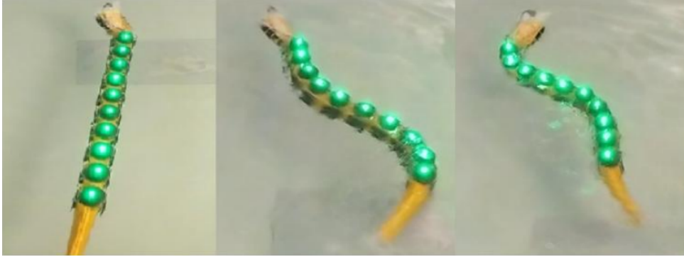
FIGURE 1 – Illustration du roulis du robot Agnathax (EPFL/Biorob) lors de sa nage à la surface libre malgré la présence de flotteurs (entourant les LEDs vertes).
