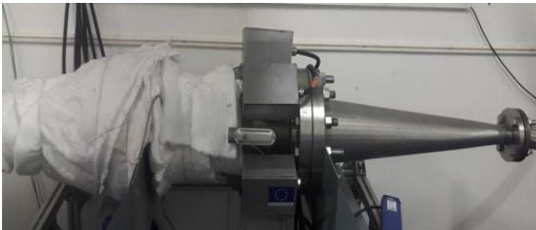
Figure 3 : Réchauffeur électrique
