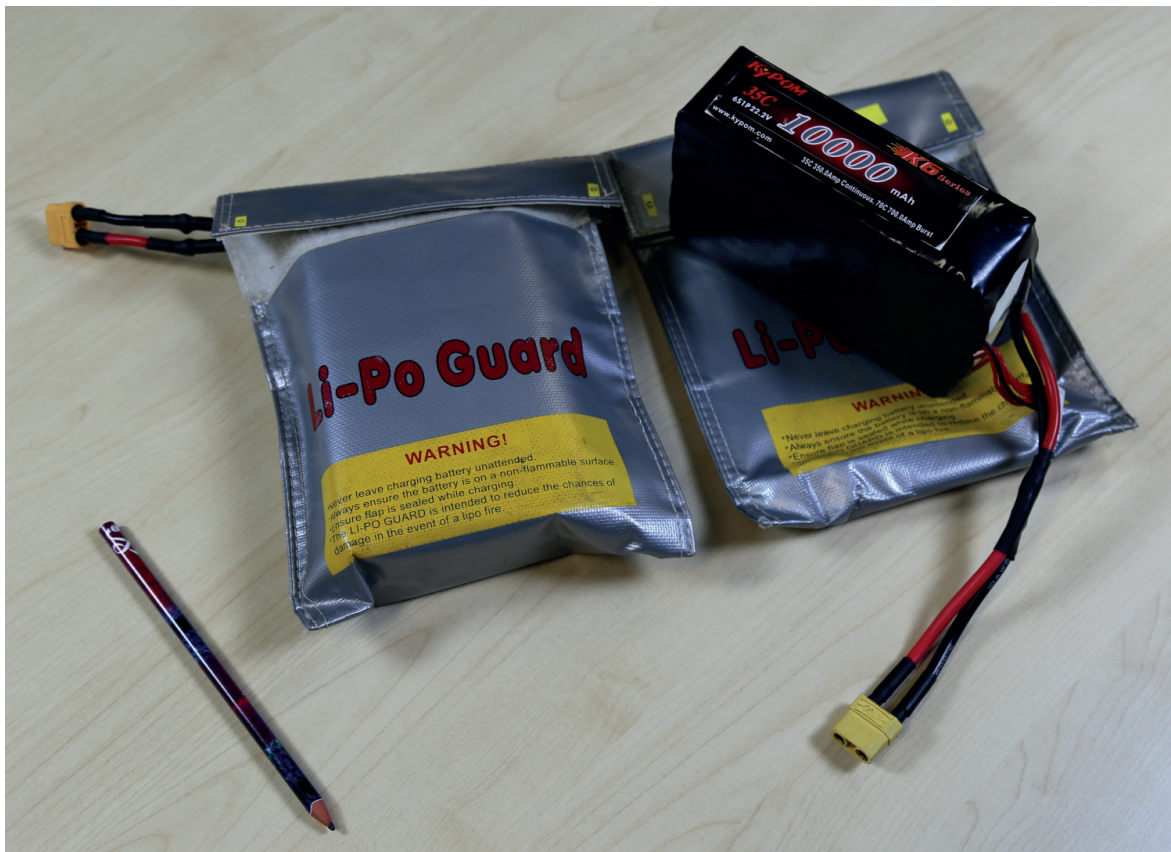
47. Conditionnement des batteries LiPo dans sacs ignifugés
