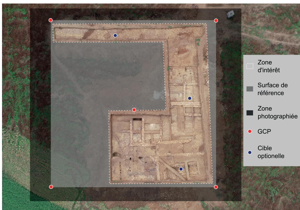
64. Placement optimal des points de contrôle au sol. Couan, Saint-Aubin-des-Chaumes, Nièvre, 2021
