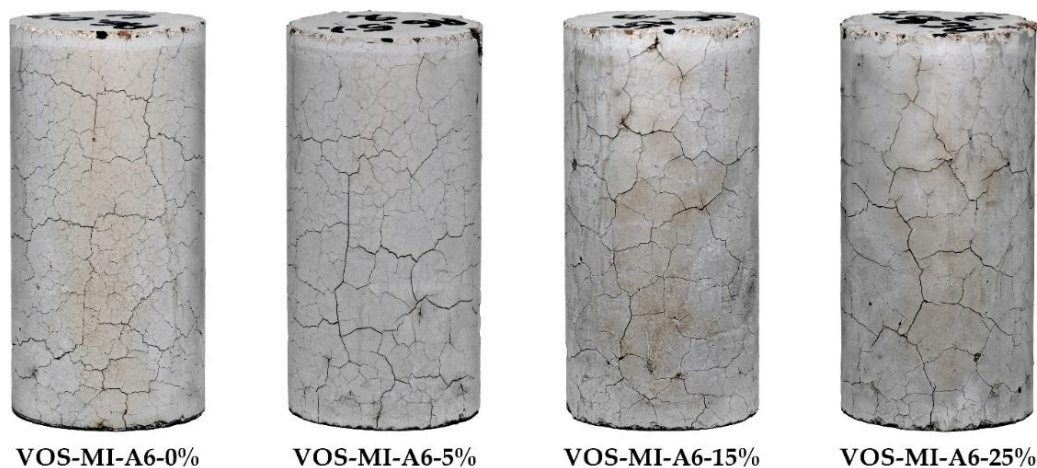
Fig. 266. Images réelles montrant l'état de fissuration sur la surface externe des éprouvettes de VOS-MI-A6 [après 6 cycles (A)] en fonction de la fraction volumiques des inclusions de sol P_{3DS} , de gauche à droite : 0 % ; 5 % ; 15 % ; 25 %
