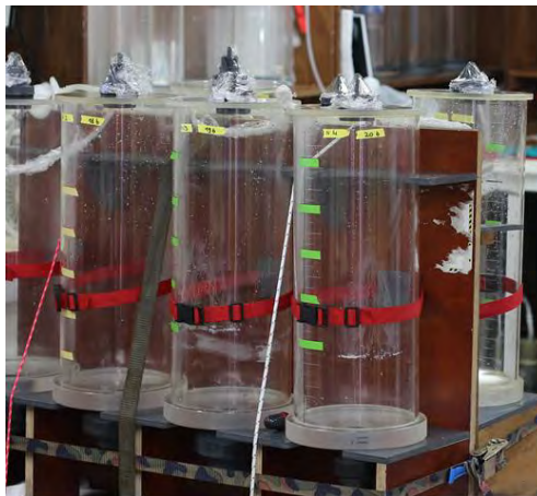
Figure 2.4 : Système de filtration Perspex® utilisé durant la campagne GEOVIDE pour la collecte de particules destinées à l'analyse du Ba_{xs} et des PREE, crédit photo Nolwenn Lemaître.
