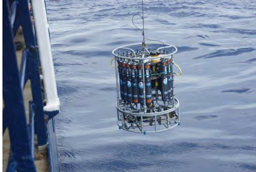
Figure A2 : déploiement de la rosette classique lors de la campagne SWINGS, photo de Pieter van Beek
