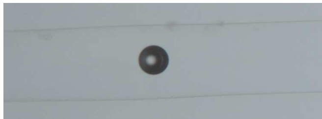
Figure IV-14 : Image au microscope d'une cavité Fabry-Pérot d'air de forme sphérique dans une fibre type SMF-28 sans membrane. Longueur de la cavité : L = 53 \mu\text{m} .
