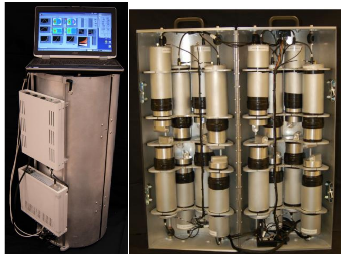
Figure I-14 À gauche : photographie du système de détection MINER. À droite : photographie de l'intérieur du système de détection MINER [50].
