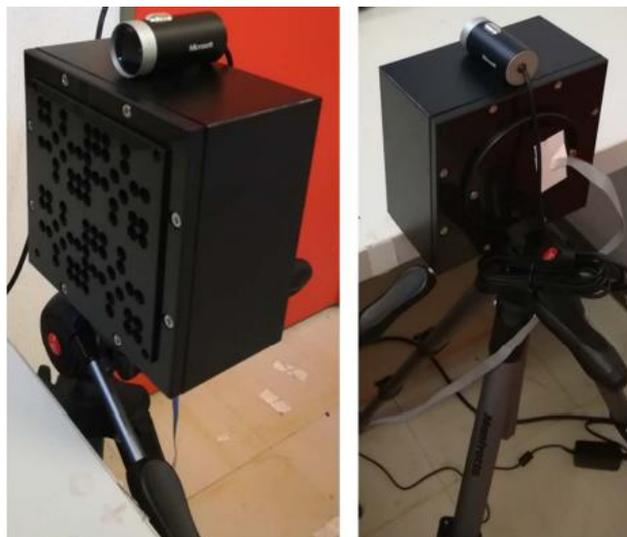
Figure I-47 Prototype expérimental de l'imageur neutronique [78].
