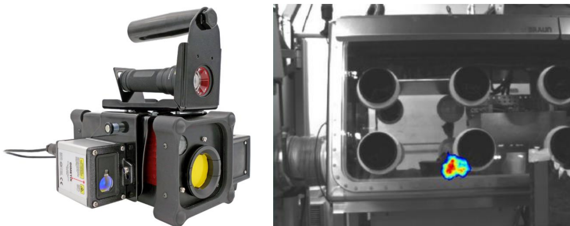
Figure 1-2 À gauche : la caméra gamma iPIX-NID. À droite : exemple de mesure d'imagerie gamma pour le contrôle de contamination dans une boîte à gants [19].
