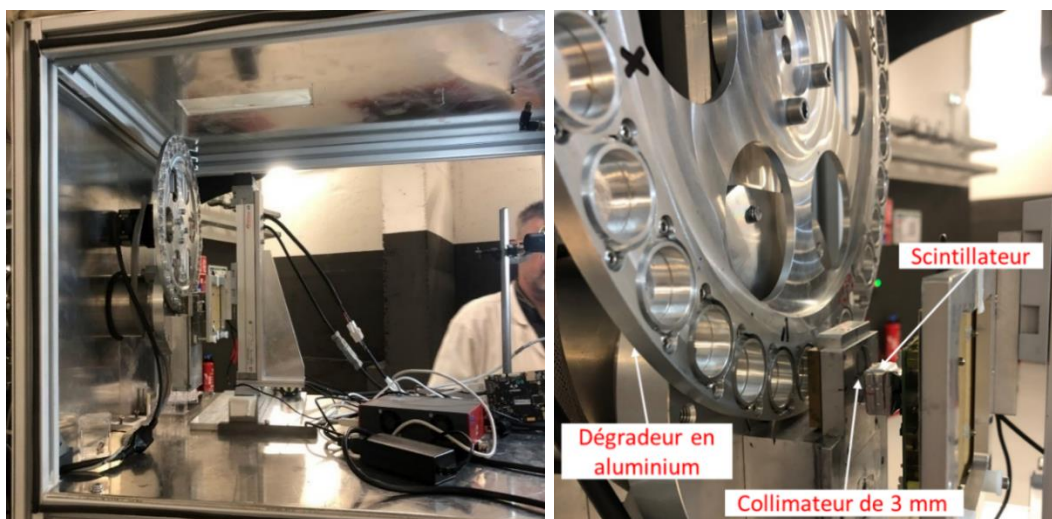
Figure III-34 Photographie montrant le montage expérimental avec la boîte à gauche où l'ensemble du prototype est placé, ainsi qu'un abri pour la lumière visible. À droite, une photographie rapprochée du scintillateur qui est positionné en face d'un collimateur de 3 mm à travers duquel les protons mono-énergétiques sont émis.
