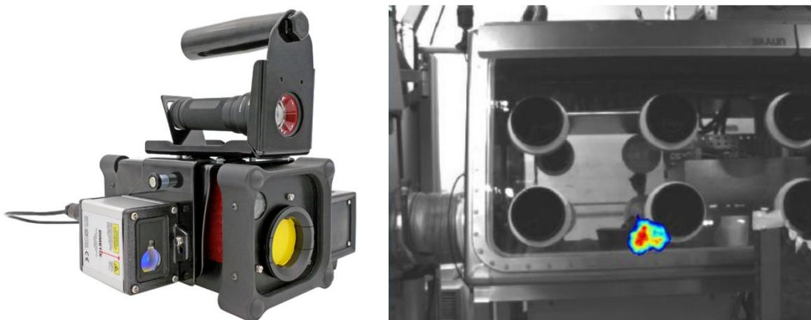
Figure 1-2 À gauche : la caméra gamma iPIX-NID. À droite : exemple de mesure d'imagerie gamma pour le contrôle de contamination dans une boîte à gants [19].
