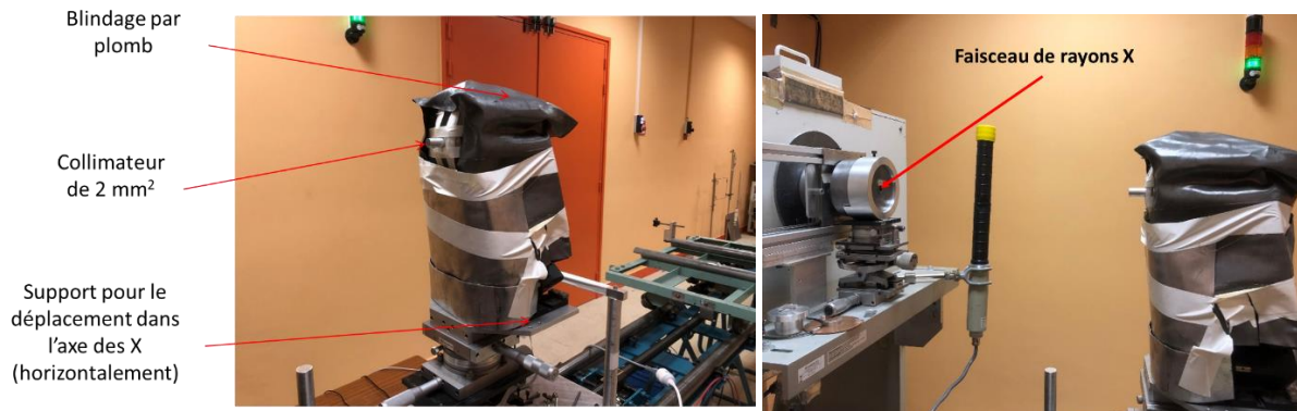
Figure IV-19 Photographie de la campagne de mesures réalisée au LNHB en irradiant le scintillateur pixellisé par un faisceau de rayons X mono-énergétiques.
