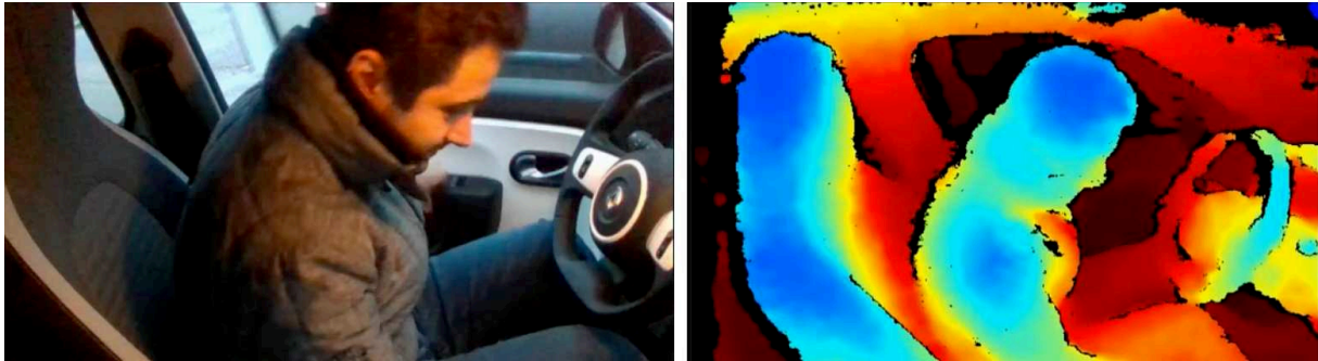
FIGURE 1.3 – Illustration d'une acquisition couleur (à gauche) et profondeur (à droite) (une colorisation de l'image de profondeur est appliquée pour aider la visualisation).
