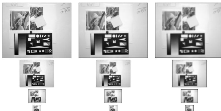
FIGURE II.11. – Illustrations de l'introduction d'une analyse multi-échelle dans une pyramide d'images (multi-résolution), extraites de [Gales 11]. De haut en bas, la résolution des images est diminuée, formant ainsi une pyramide d'images. De gauche à droite un filtrage gaussien est appliqué avec un filtre de plus en plus grand, pour fournir une analyse multi-échelle.
