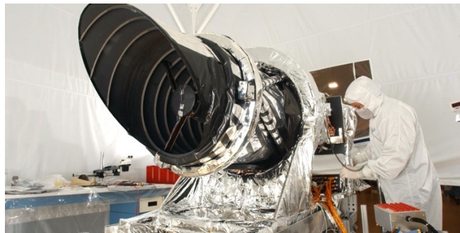
Figure 4.16. L’instrument HiRISE lors de la phase d’assemblage ( mars.nasa.gov/mro/mission/instruments/hirise/ ).
