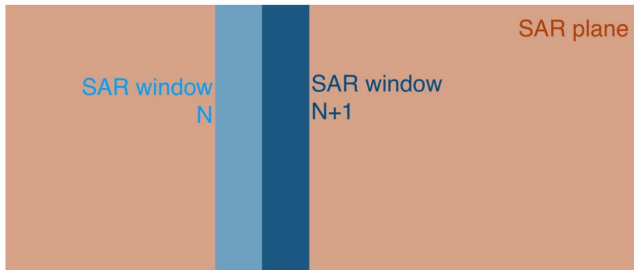
Figure 2.14. Schéma du fonctionnement de la synthèse dite « par morceaux »
