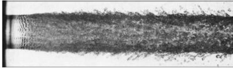
Fig. III.1-2: Apparition d'instabilités hydrodynamiques sur un jet liquide à haute vitesse [39]
