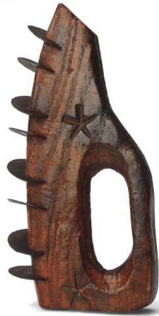
d Chemin de fer de tailleur de pierre, L. 127 mm, l. 17 mm (Feller et al. 2004, p. 196-197 ; Maison de l'outil et de la pensée ouvrière, Troyes)
