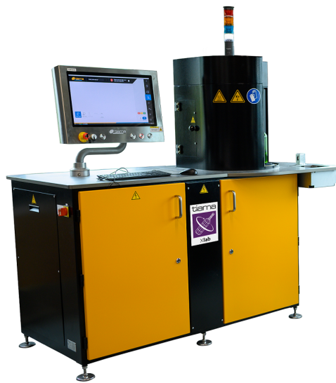
FIGURE 18 – Tomographe Tiama XLab (image fournie par Tiama )
