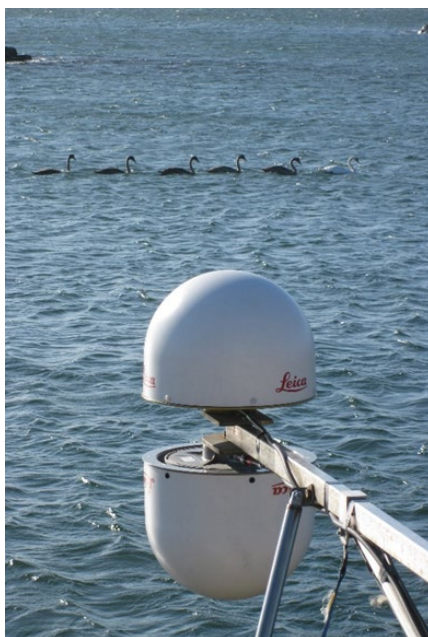
Figure 43. Système de réflectométrie à double antenne. Une antenne pointe vers le zénith et une seconde antenne vers le nadir. Source : [69].
