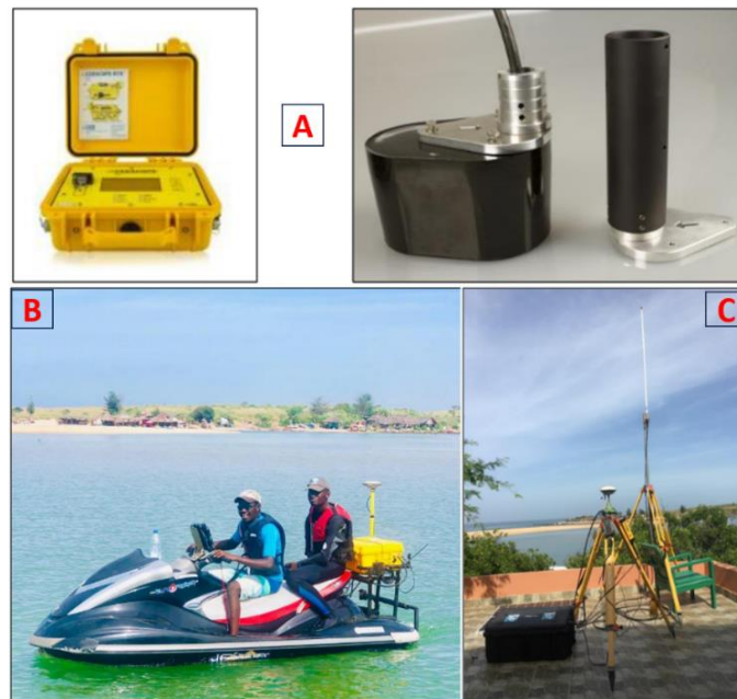
Figure 3.2. Instruments déployés durant les levés bathymétriques dans la lagune de la Somone, ( A ) un échosondeur monofaisceau à bi-fréquence (modèle CEESCOPE) ; ( B ) un jet-ski flexible (moyen nautique) pour les levés, ( C ) une station de référencement (munie d'un DGPS (RTK-GNSS) et d'une antenne relais).
