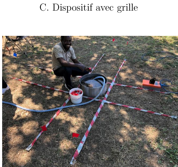
Figure III.10 : Photos des différents dispositifs utilisés : A) grille de 12 transects avec le petit anneau, B) passage du GPR le long d'une règle en bois, C) grille de 4 transects avec le grand anneau, et D) dispositif automatisé conçu et utilisé en Australie.
