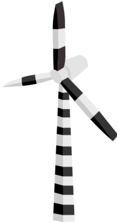
Figure 30. Motif proposé par Martin et Banks (2023) pour réduire les collisions aviaires au niveau des éoliennes installées en mer. Chaque pale est divisée en trois, avec deux parties noires et une partie blanche pour deux des pales, et une partie noire et deux parties blanches pour la troisième, afin de maximiser le contraste sur toute la surface balayée par les pales. L'inversion des parties noires et blanches sur une des pales ainsi que les rayures sur le mât permettent de limiter le flou de mouvement lorsque les pales sont en rotations. Sur le mât, la longueur de chaque section est égale à la moitié des sections du motif des pales.
