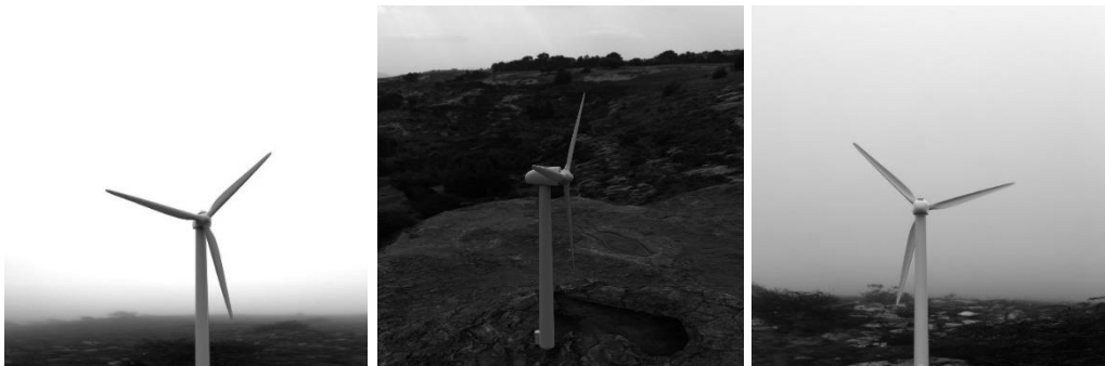
Figure 25. Modélisations d'une éolienne dans différents environnements et selon différents points de vue. Sur ces images, l'éolienne possède les mêmes caractéristiques de réflectance que l'un des échantillons de pale. Chaque pixel est codé selon une valeur de luminance.
