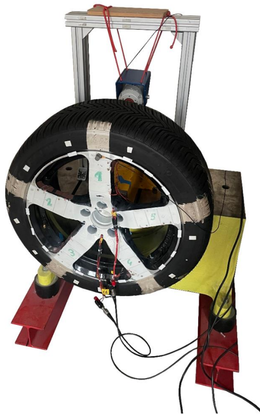
Figure 5.1 - Définition du banc d'essai statique du modèle 1:1 utilisé pour l'étude au vibromètre laser
