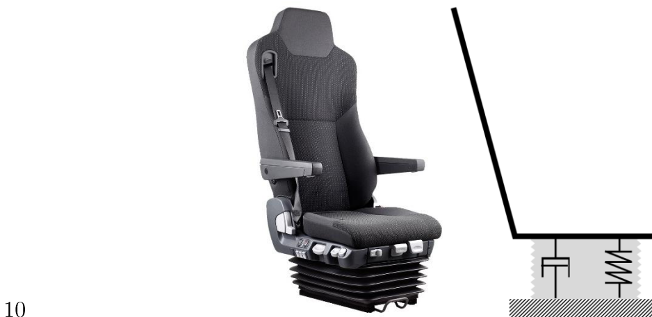
Figure 2.9 - Système d'isolation d'un siège de camion MAN TGX
