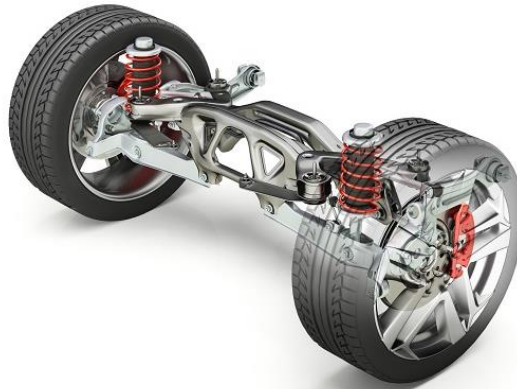
Figure 2.10 – Système ressort-amortisseur d'un véhicule
