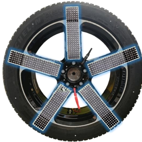
Figure 4.2 - Exemple de nuage composé de 945 points utilisé pour discrétiser la surface d'un ensemble monté
