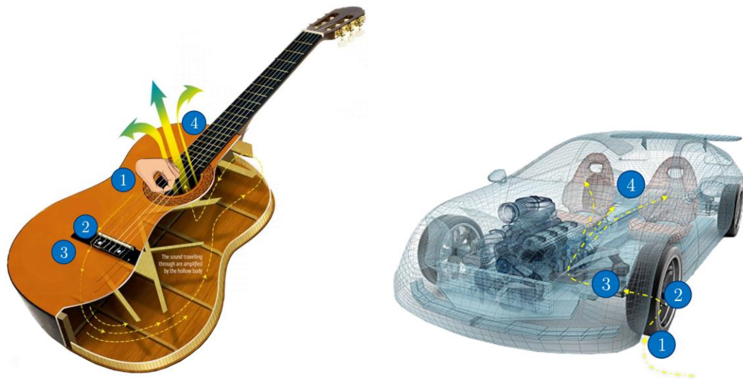
Figure 1.2 : Chemin de propagation des vibrations dans un instrument à cordes et dans un véhicule
