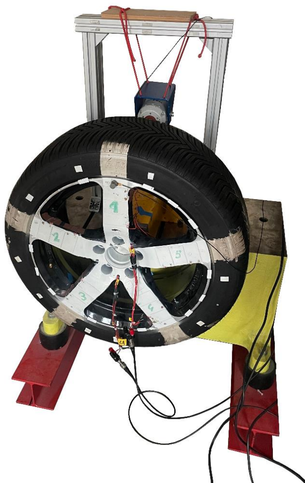
Figure 3.1 - Banc d'essais statique équipé d'un ensemble monté
