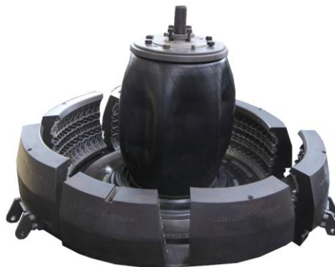
Figure 4.15 – Moule en 8 parties de formage et de cuisson d'un pneumatique Michelin
