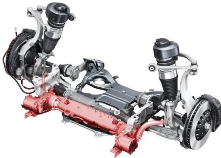
Figure 2.15 - Suspension active de train arrière d'Audi A8
