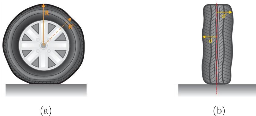
Figure 4.11 – Voilage radial (a) et latéral (b) d'un pneumatique
