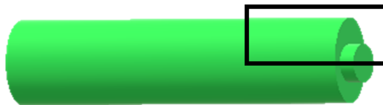
Figure 53 : Observation d'une cellule par radiographie lors de l'emballage thermique. Le rectangle noir représente la partie de la cellule observée.
