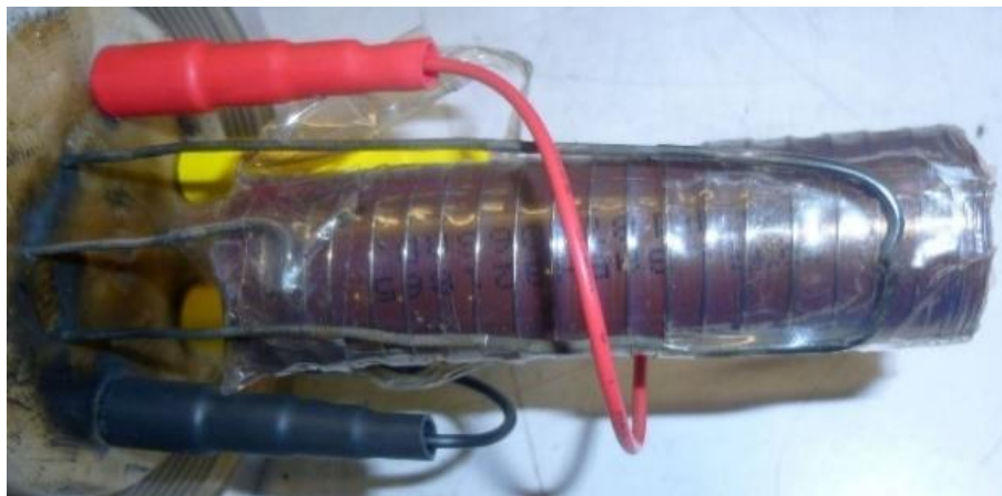
Figure 50 : Cellule instrumentée avec les fils de tension en rouge et noir et les fils résistifs en jaune.
