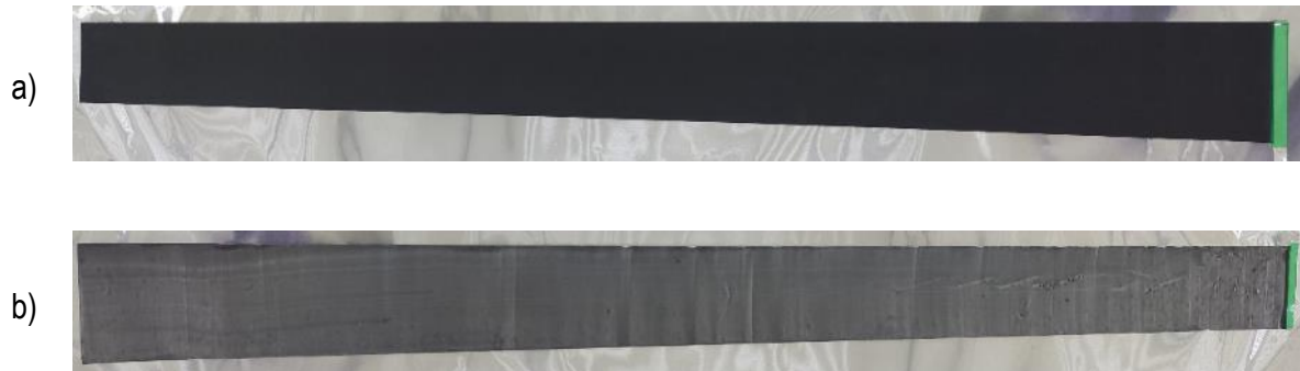
Figure 49 : Électrode positive de la cellule LG-HG2 a) avant l'enduction et b) après l'enduction de LLZO.
