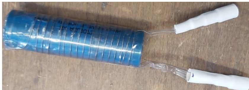
Figure 75 : Cellule entourée d'un fil chauffant permettant le déclenchement de l'emballement thermique.
