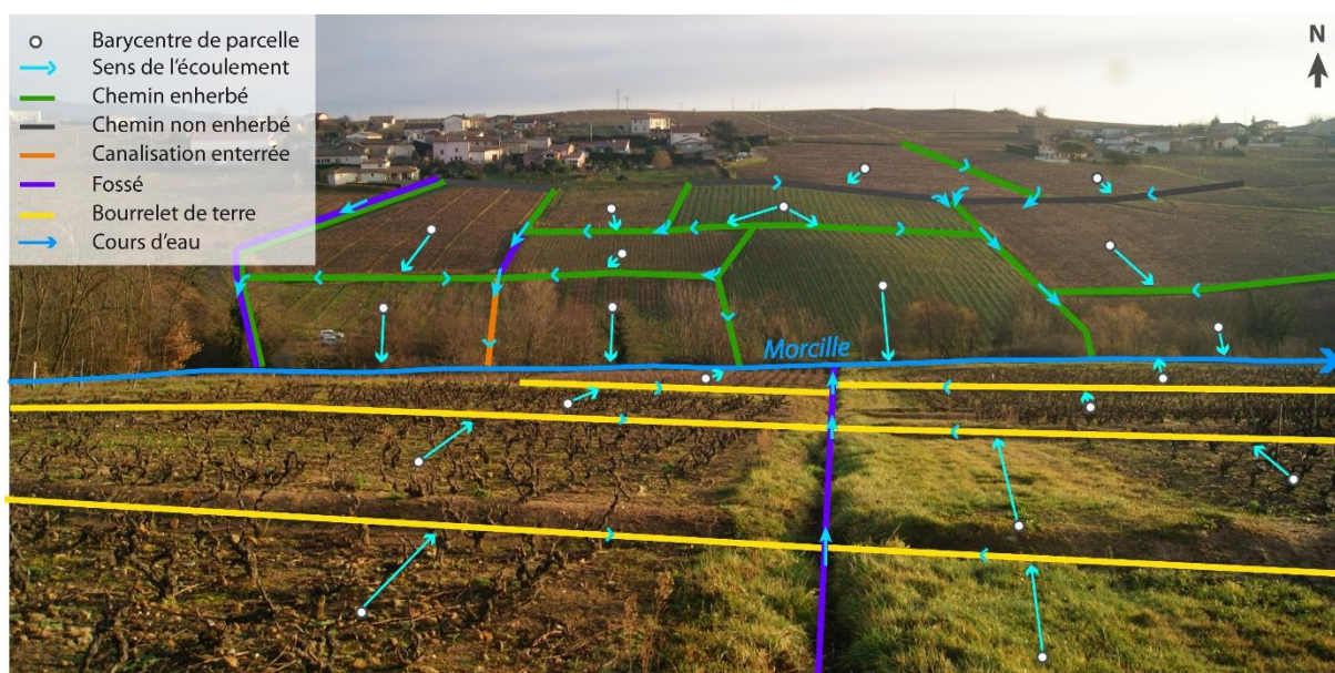
Figure 4-12 : Schéma d'organisation du cheminement des sédiments dans le paysage, bassin versant de la Morcille.
