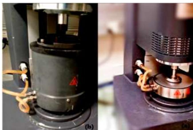
**Figure 30.** Rhéomètre de géométrie cône-plan-lisse (a), géométrie de cylindre concentrique (b) (Photo personnelle).
