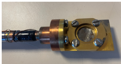
FIGURE II.17 – Porte-échantillon utilisé pour les mesures Mössbauer.
