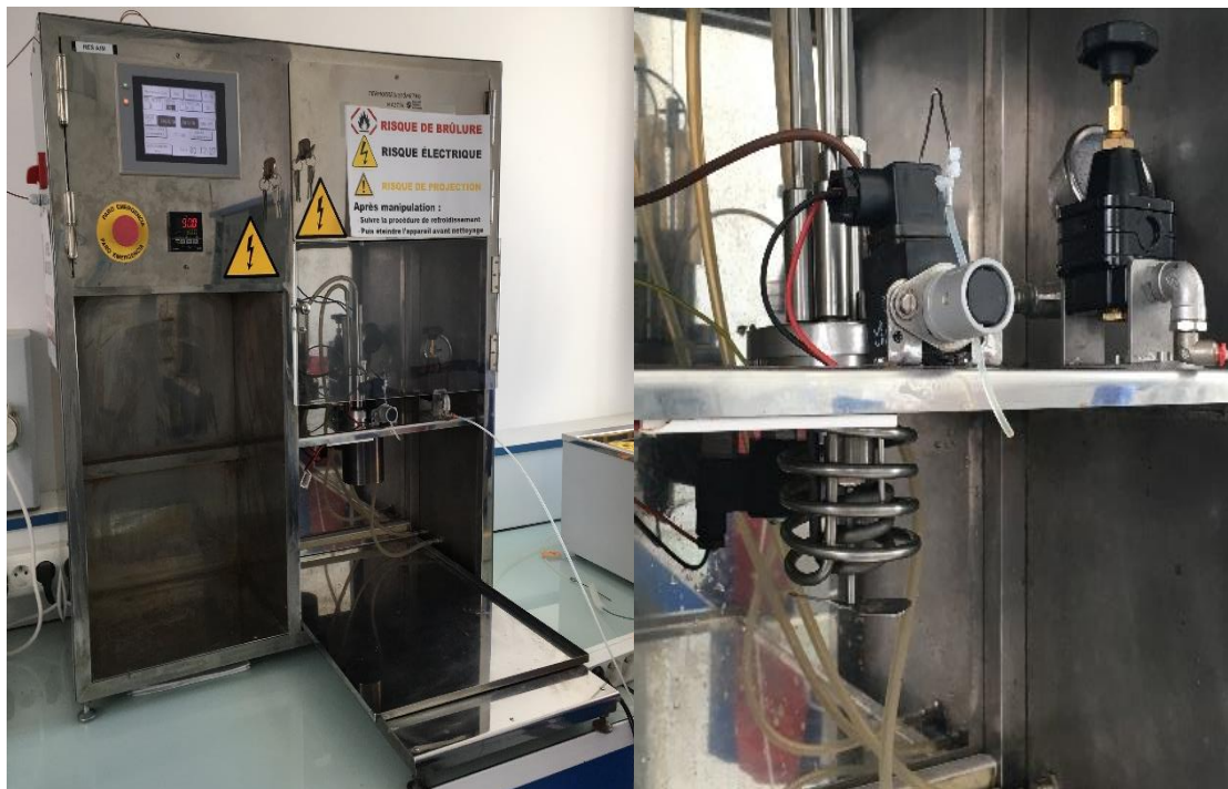
Figure 50 : Thermoresistomètre Mastia (à gauche) et détails de sa résistance (à droite) (Photo C.P.C.C. Martins)
