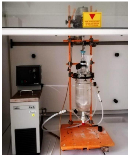
Figure 68 - Réacteur de lixiviation utilisé pour les essais de lixiviation, thermostaté à 30 °C par un bain d'huile de silicone.
